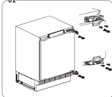
3. Capovolgere la cerniera e posizionarla sulla parte diagonalmente opposta dell'armadio. Avvitare di nuovo in posizione. Ripetere l'operazione con l'altra cerniera. Sostituire l'anta e rimontare le cerniere. Controllare che la porta sia allineata orizzontalmente e verticalmente e che le guarnizioni della porta siano fissate su tutti i lati prima di serrare definitivamente le viti della staffa della cerniera.
