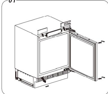
2. A porta chiusa, rimuovere le viti all'esterno delle cerniere. Aprire le cerniere lontano dalla porta. Con la cerniera aperta, allentare le viti che la fissano al mobile. Fare attenzione alla cerniera, utilizzare un cacciavite lungo se ne avete uno.
