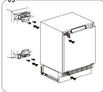
4. Riposizionare il coperchio superiore della cerniera (a sinistra e a destra). Riposizionare il coperchio inferiore del foro per le viti del mobile. Riposizionare il coperchio del foro della vite per la porta.
