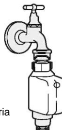
tubo di alimentazione di sicurezza
