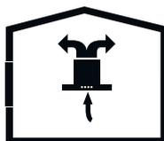
*Fig. 4: Circolazione dell'aria del filtro a carbonio*
