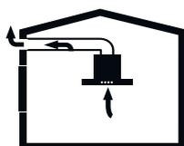
Fig. 4: Scarico d'aria senza filtro a carbone
