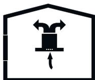
Fig. 5: Circolazione dell'aria del filtro a carbonio
