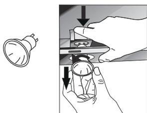
Per la sostituzione delle lampade alogene, spingere verso il basso sul supporto della lampada dal suo retro, girare leggermente in senso antiorario e portarlo verso il basso. Fig. 15
